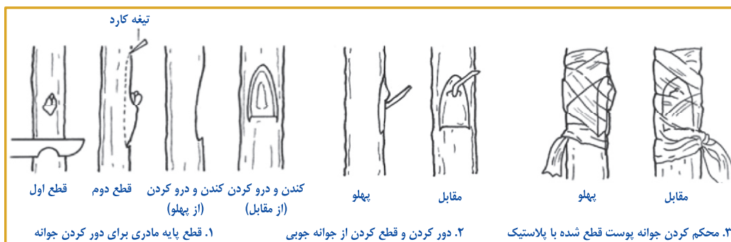
شکل ۲۹: مراحل اجرای پرخچه پیوند یا chip budding (بر گرفته از ۱۹۹۷، Hartman et al.)
